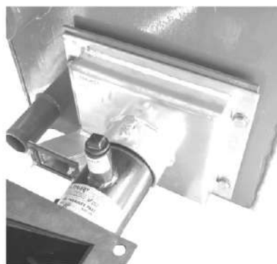
Рисунок 3 – Место установки механизма подачи топлива
